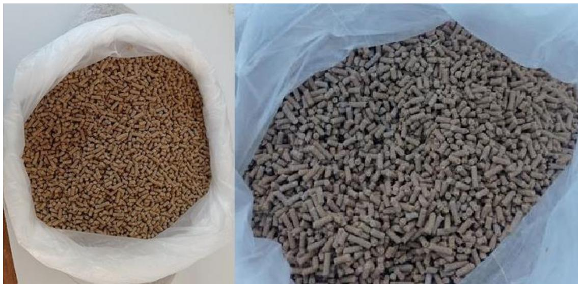
*Ilustración 4.2. Pellets fabricados por medio de la peletizadora industrial*
